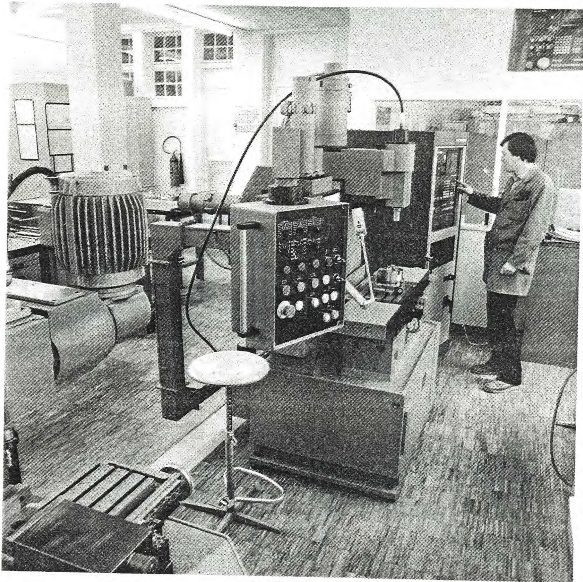
- Die Mikromechaniker lernen auf einer computergesteuerten Fräsmaschine (CNC) arbeiten
