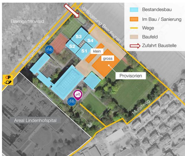
Auf dem Rasenspielfeld 2 vor den vier Sporthallen (S1-4) werden ein grosses und ein kleines Provisorium eingerichtet. Vor der Installation dieser Provisorien müssen noch Erdsonden und Erschliessungsleitungen verlegt werden.
