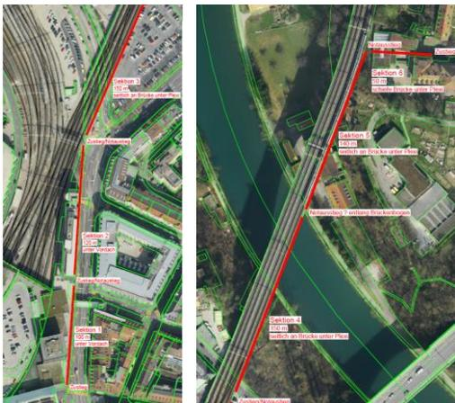
Zur Entlastung der Linie 20 im Querschnitt Lorraine wird mit einem (gedeckten) **Rollband** zwischen Bahnhof Bern und Gewerbeschule der Fussweg attraktiver gemacht. Die Skizze zeigt eine mögliche Führung ab dem Bahnhofplatz (Bereich Haltestelle Linie 20) mit einer Aare-Querung parallel zur Eisenbahnbrücke.
