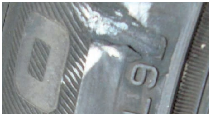
Kleine Schrammen, Stahlchord und Abdecklage nicht sichtbar.
