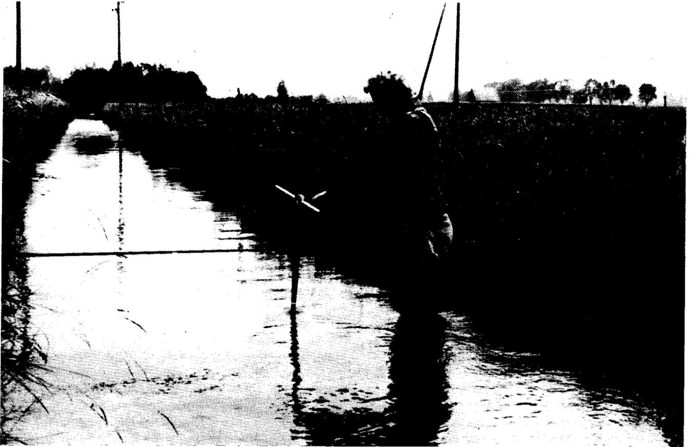
Fig. 3.6 Abflussmessung mit dem Tauchstab. Grundwasseraustritt Mühlebach, Schalunen.
