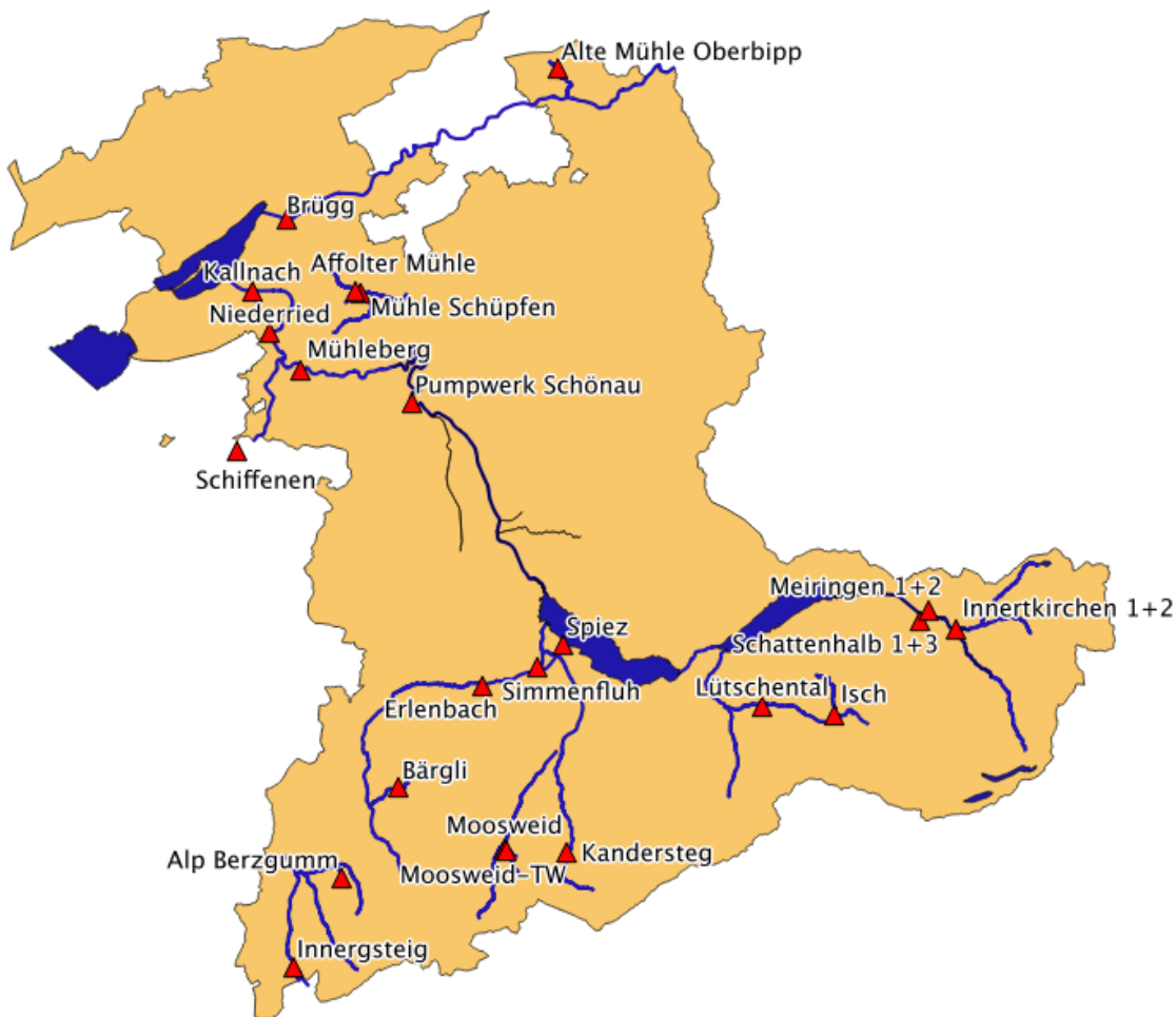
Abbildung 2: Geografische Skizze zu den möglicherweise schwallverursachenden Kraftwerken (Rote Dreiecke: Wasserrückgabe) im Kanton Bern.
