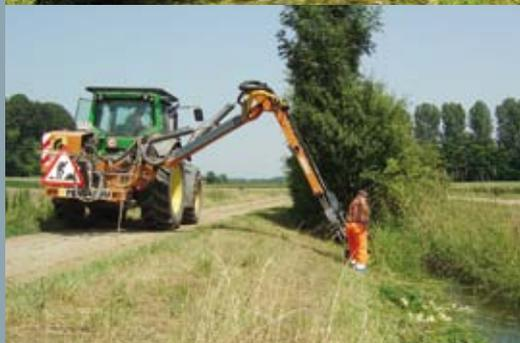
Gut erschlossene Böschungen können rationell mit einem Auslegermäherwerk unterhalten werden.
