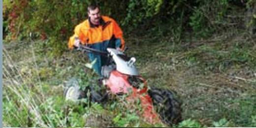
Das Mähen steiler Böschungen oder alter Wiesenbestände ist aufwändig und nur mit Doppelbereifung möglich.
