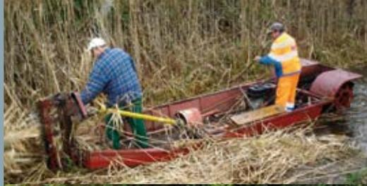
In grösseren Kanälen wird der Wasserpflanzenschnitt (hier Schilf) mit dem Mähboot durchgeführt.
