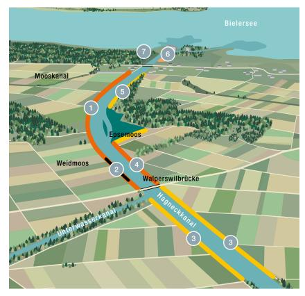
Mit einer Reihe von **baulichen Massnahmen** wurden die bestehenden Hochwasserschutzdefizite am Hagneckkanal behoben und die Probleme beim rutschgefährdeten Hagneckeinschnitt entschärft:
