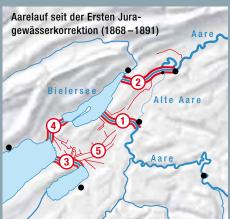
Der Hagneckkanal (1) ist die Schlüsselstelle der Juragewässerkorrektion. Doch zum Gesamtwerk gehören auch die zum Nidau-Büren-Kanal (2) erweiterte und begradigte Zihl, die kanalisierte Broye (3) zwischen Murtenund Neuenburgersee und die kanalisierte Zihl (4) zwischen Neuenburgerund Bielersee. Abgerundet wurde das beeindruckende Vorhaben durch die sogenannte Binnenkorrektion zur Entsumpfung des Grossen Mooses (5) und weiterer Gebiete.
