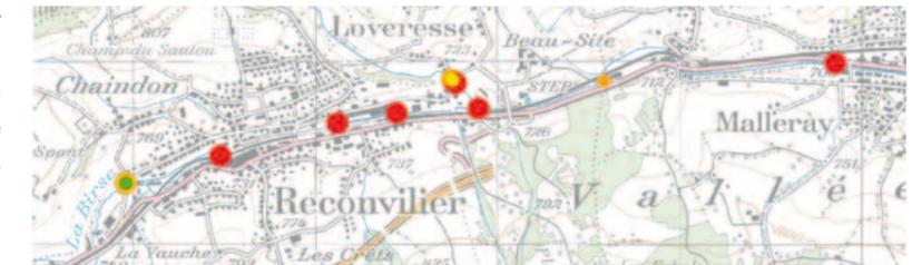
Beurteilung der Kupferbelastung in Wasserproben (kleine Punkte) und Sedimenten (grosse Punkte) nach dem Modul-Stufen-Konzept (MSK) – hier mit einem vergrösserten Ausschnitt der Gegend um Reconvilier im Birs-tal, wo übermässige Kupferkonzentrationen auftreten.
