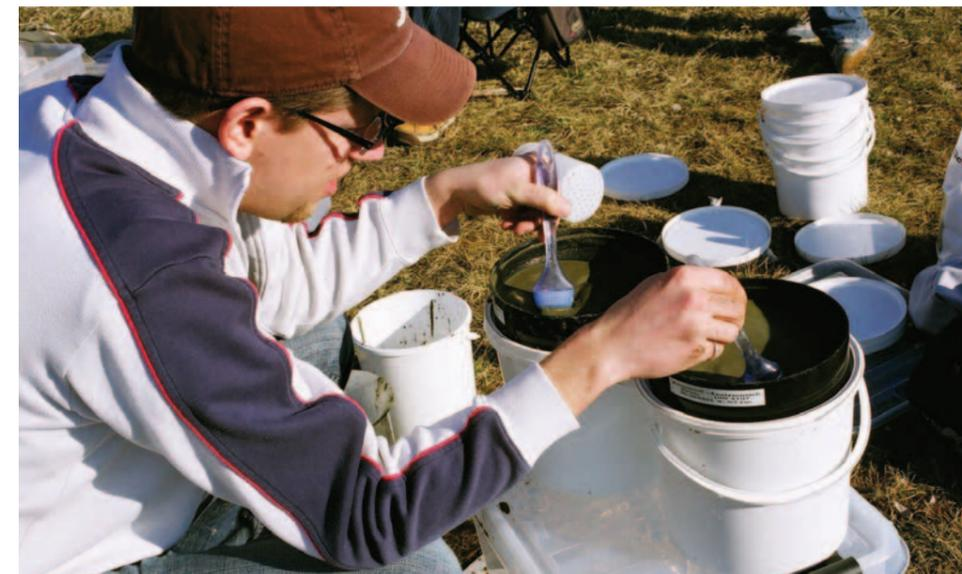
Als Vorbereitung zur Analyse von Flusssedimenten werden diese auf kleine Korngrössen gesiebt. Solche Untersuchungen eignen sich vor allem, um die Entwicklung der Schwermetallbelastung in den Gewässern über einen längeren Zeitraum zu verfolgen.
