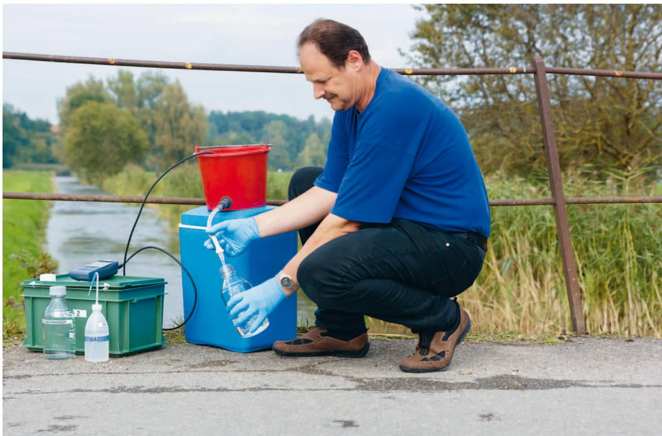
Entnahme von Wasserproben aus der Urtenen an der Hauptmessstelle bei Schalunen.
