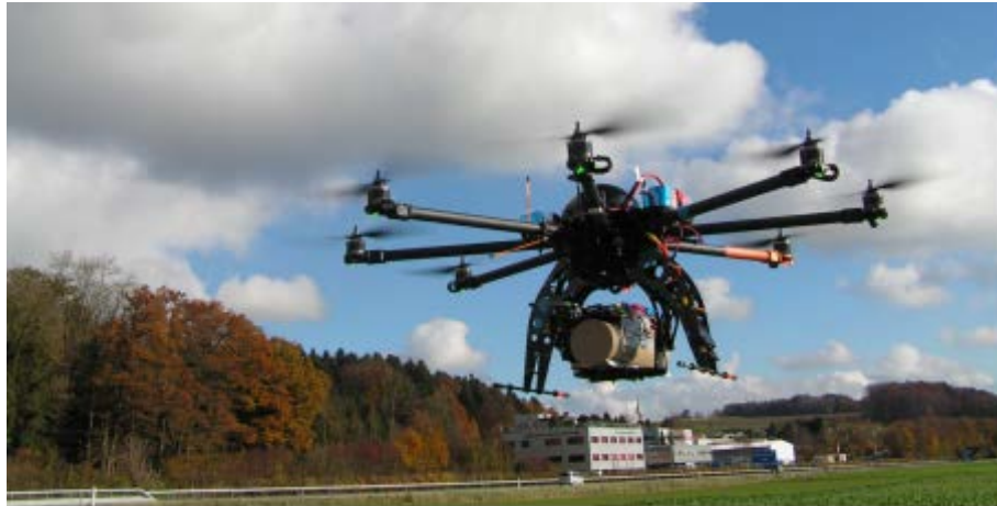
Abbildung 2: Drohne mit Dosisleistungs-Messgerät
