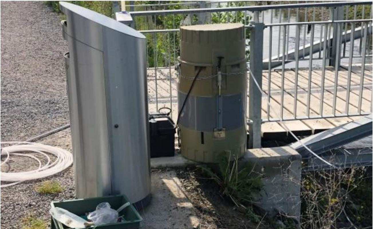
Abbildung 4: ISCO Sampler zur automatischen Wasserentnahme an der Stelle GI01.
