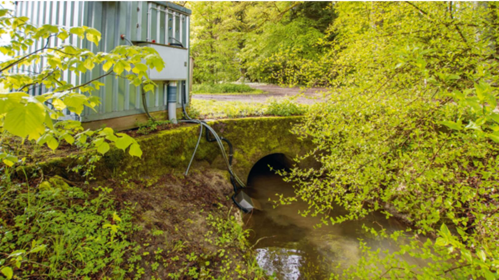
Messstelle des GBL zur Überwachung der diffusen Einträge von PSM in den Chrümlisbach bei Bätterkinden.
