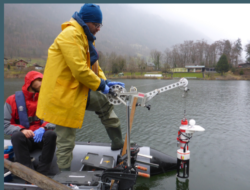
Die Sonde wird für die Tiefenprofile von Temperatur, Sauerstoff und weiteren Parametern herabgelassen.
