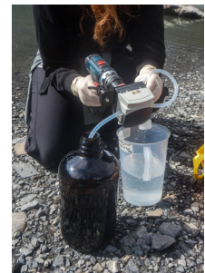
Feldarbeit zur eDNA-Probenahme: Wasser wird sorgfältig gefiltert, um genetische Spuren aquatischer Organismen zu erfassen
