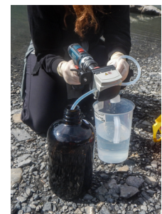
Feldarbeit zur eDNA-Probenahme: Wasser wird sorgfältig gefiltert, um genetische Spuren aquatischer Organismen zu erfassen
