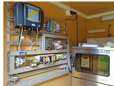
An dieser Messstelle bei Bätterkinden (oben) überwacht das GBL die diffusen Einträge von Pestiziden in den Chrümmlisbach mit seinem landwirtschaftlich dominierten Einzugsgebiet. Das Innenleben eines typähnlichen Containers besteht aus dem gekühlten, automatischen Probenehmer (unten) und weiteren technischen Installationen. Auf den Displays lassen sich Wassertemperatur, pH-Wert, Leitfähigkeit und die Abflussmenge des Fliessgewässers ablesen.
