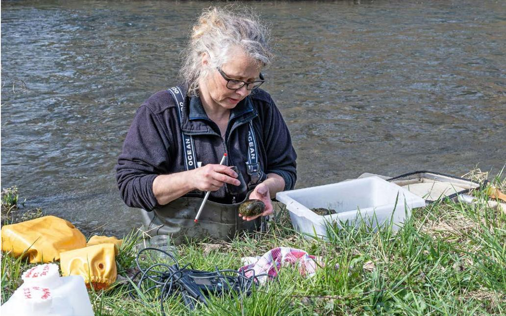
Für die Probenahme von Kieselalgen kratzt man eine definierte Fläche bewachsener Steine ab und bestimmt die Kieselalgen danach im Labor.
