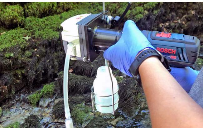
Bei der eDNA-Probenahme mit dieser akkubetriebenen Schlauchpumpe wird das Quellwasser durch einen Filter gepumpt, in dem die Erbsubstanz der Wasserorganismen haften bleibt.
