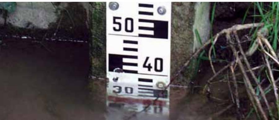
Pegellatte zur Kontrolle des Wasserstands in einem Bach. Die rote Marke zeigt die minimale Restwassermenge an.
