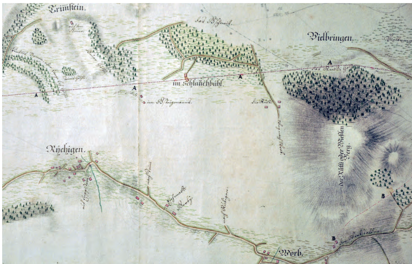
Karte 5: Ausschnitt aus dem Plan von Andreas Lanz, Geometer und Leiter der Berner Artillerieschule, für eine neue Linienführung der Strasse Bern-Grosshöchstetten von 1783. Erwähnenswertes Detail dieses Planes sind die mit A bezeichneten Standorte für Kiesgruben, die für den Unterhalt der neuen Strasse als nötig erachtet wurden. (Quelle: StA-Be, AA VIII 75)
