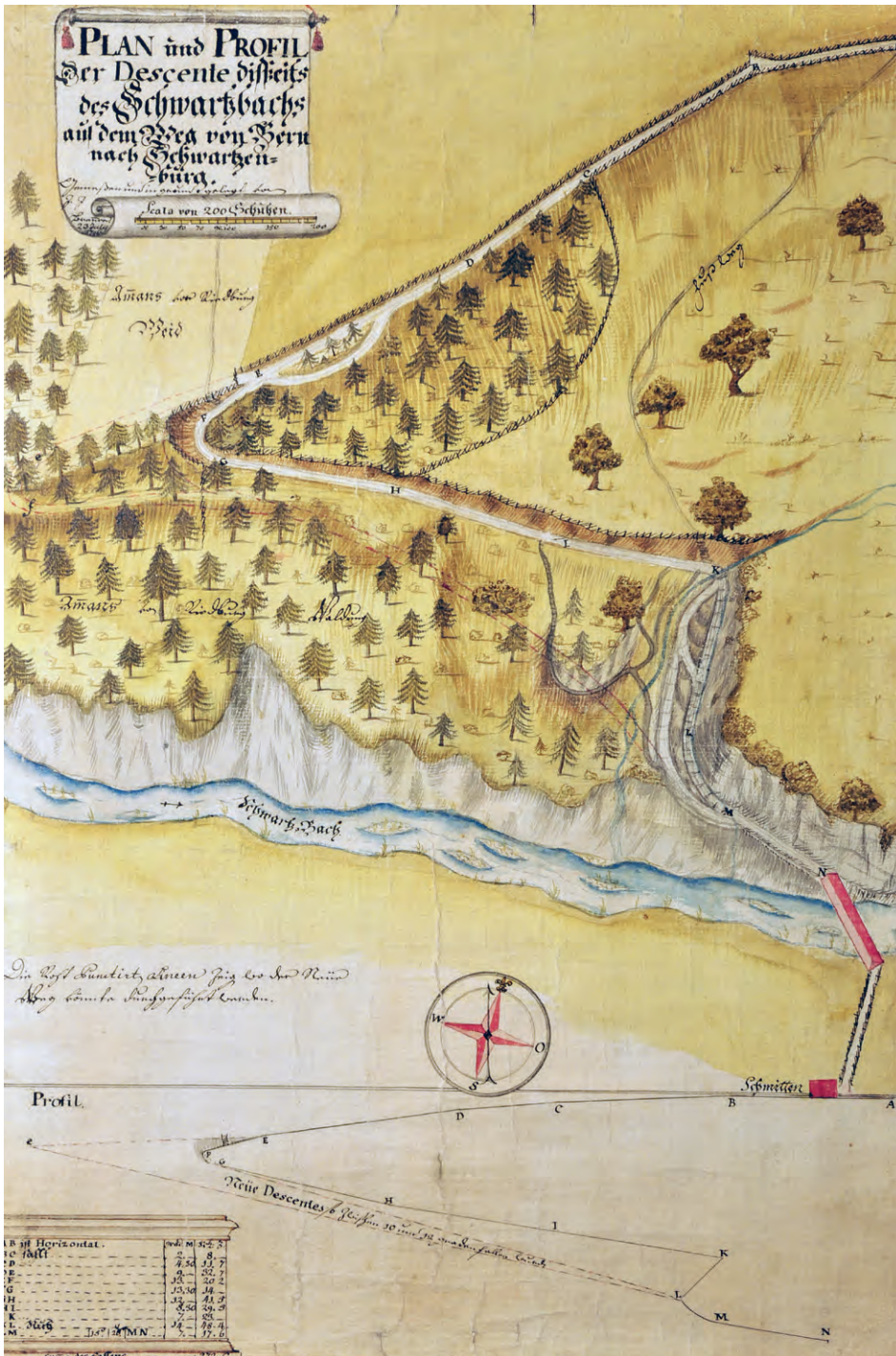
Karte 4: Der Plan von J.J. Brenner von 1746 zeigt einen ersten Vorschlag zur Entschärfung des steilen Abstiegs der Fahrstrasse Schwarzenburg-Bern zum Schwarzwasser südlich von Mittelhäusern. Der für schwere Fuhrwerke heikle Schwarzwasser-Übergang, zum dem die Strasse bis 1822 mit einem Gefälle von bis zu 23 Prozent 70 Meter tief hinter führte, sollte bis zum Ende des 19. Jahrhunderts ein zentrales Hindernis für den Warenaustausch und den wirtschaftlichen Aufschwung des Schwarzenburgerlandes bleiben. Erste Verbesserungen erfolgten 1822 mit einer verbreiterten und tief in die Sandsteinfelsen eingeschnittenen Linienführung. Doch erst mit dem Bau der 170 Meter langen Schwarzwasserbrücke 1882 konnte das Gefälle auf 2,5 Prozent verringert und die Länge des Überganges um 460 Meter markant verkürzt werden. (Quelle: StABe, AA VIII 25; Staatsverwaltungsbericht 1814–31, S. 390 und 1882, 47–49)
