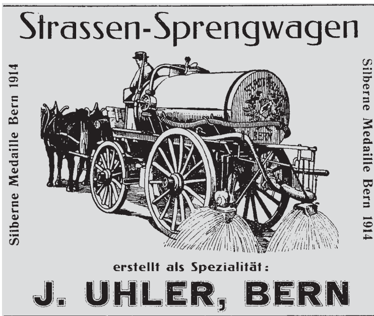
Abb. 26: Inserat aus der Schweizerischen Zeitschrift für Strassenwesen aus dem Jahr 1920. Die Besprengung der Schotterstrassen mit Wasser oder auch mit Wasserglas (flüssiges Kalium- oder Natriumsilikat als Bindemittel) war bis nach dem Ersten Weltkrieg eine der hauptsächlichlichen Massnahmen gegen den Strassenstaub. Das in Bern fabrizierte Modell wurde an der Landesausstellung von 1914 prämiert.
