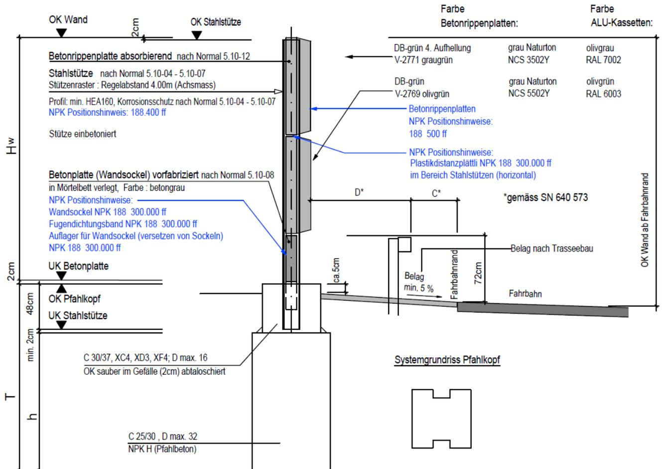
**Sämtliche Fugen sind schalldicht auszubilden.**
