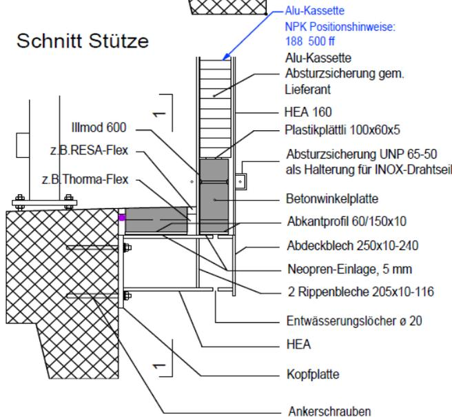
Betonwinkelplatte mit Absturzicherung
