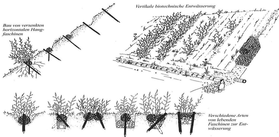
Wirkung: Durch die Hohlräume in der Faschine fliesst überschüssiges Wasser rasch ab. Zum andern verbrauchen die Weiden während der Vegetationszeit sehr viel Wasser (= Wasserpumpen). Mit der fortschreitenden Verwurzelung im tiefsten Bereich einer Rinne verhindern sie aktiv deren Erosion.
