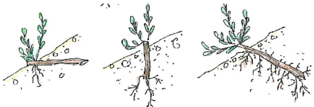
Am besten bewurzelt Holz, welches schräg von tief unten nach oben an die Oberfläche verlegt wird (bei steilen Hängen etwa rechtwinklig zur Hangoberfläche).
