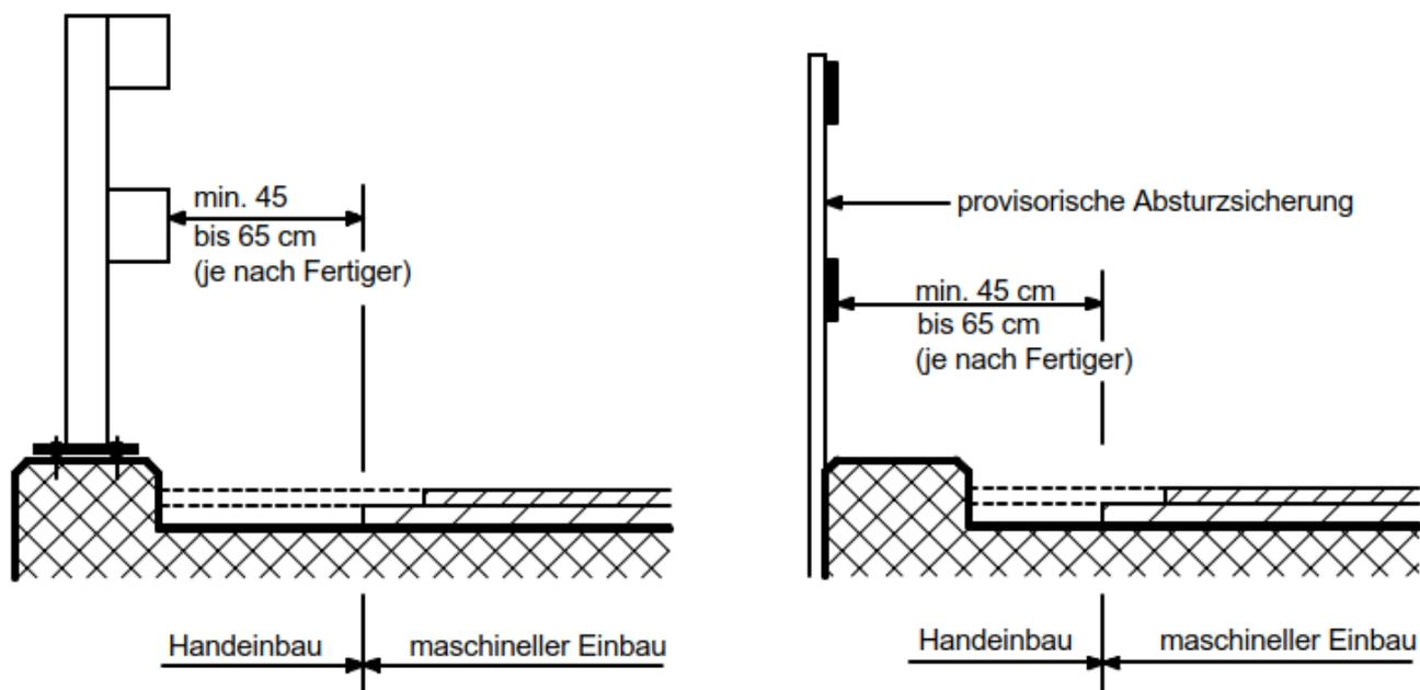
Ein Randstreifen in Handeinbau ist unerlässlich, wenn der Überhang des Einbaufertigers ab Bohlenende nicht ausserhalb der Fahrbahn Platz findet.
