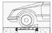
Aushebefeile entgegen der Fahrtrichtung!
