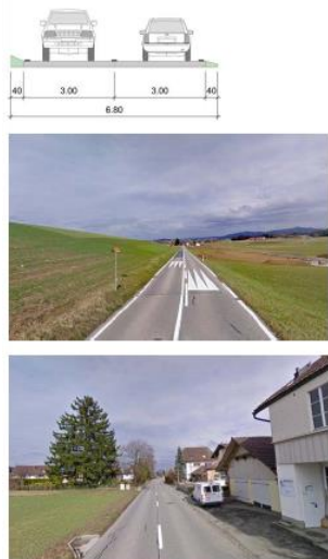
Abb.: Systemquerschnitt Ortschwabenstrasse ausserorts, Mit. 1:125; Fotos Ortschwabenstrasse ausserorts und Ortseingang Ortschwaben
