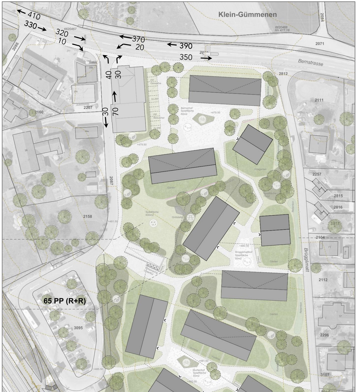
Abb. 2: Massgebende Verkehrsbelastung im IST-Zustand (2020)
