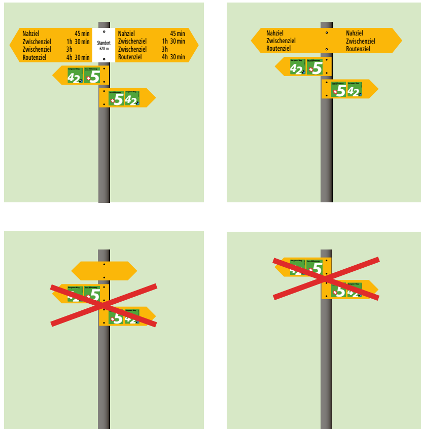
Abb. 18 Montagehinweise für Wegweiser mit Routenfeldern.
