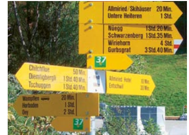
Abb. 25 Beispiel einer Anordnung der Wegweiser mit Routenfeldern
