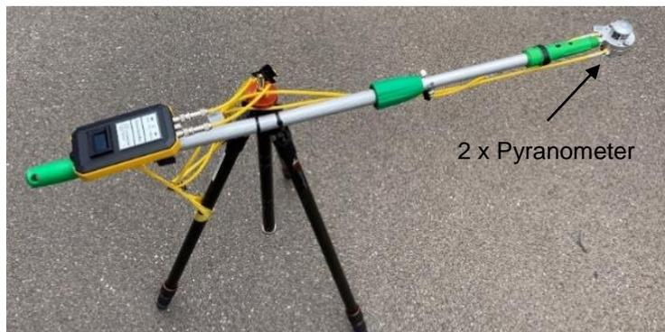
Abbildung 10: Albedometer zur Bestimmung der Belagsalbedo.
