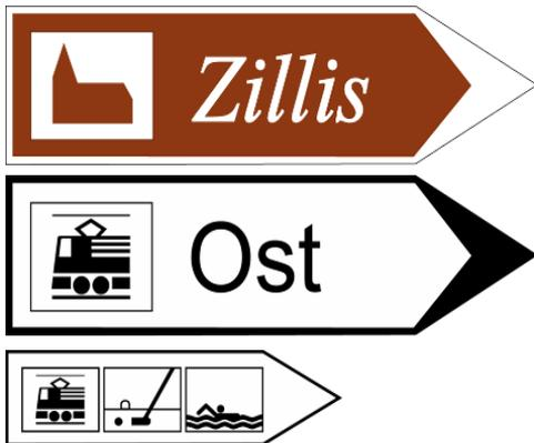
Wegweiser stehen dort, wo über den einzuschlagenden Weg Zweifel bestehen. Das Aufstellen der Wegweiser in Kombination mit anderen Wegweisern ist in der VSS-Norm SN 640 846 geregelt.
