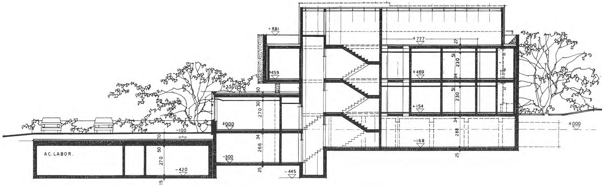
SCHNITT A-A', AC LABOR UND ERWEITERUNGSBAU
