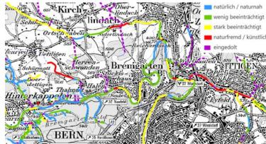
Le terme d'écomorphologie désigne les caractéristiques structurelles d'un cours d'eau et des abords de celui-ci. Le relevé et l'évaluation écomorphologiques se font par tronçon de cours d'eau, à l'aide de différents paramètres.
