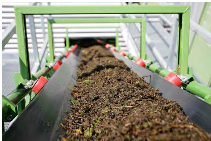
Déchets biogènes broyés en route vers le digesteur Photo : Axpo Biomasse AG
