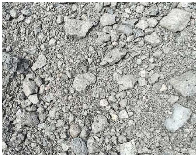
Granulats de mâchefer, plan rapproché (photo : Stahlwerk Gerlafingen)
