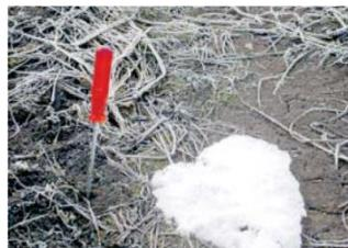
Le sol est « gelé » lorsqu'il n'est plus possible d'y enfoncer un objet pointu (p. ex. un tournevis ou un couteau).
