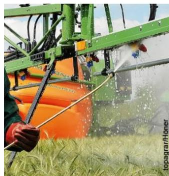
2<sup>e</sup> étape : Si un nettoyage supplémentaire est nécessaire (avec ou sans adjuvant) et que l'eau de lavage ne peut pas être répandue sur la surface traitée, il doit s'effectuer sur la place de lavage.
