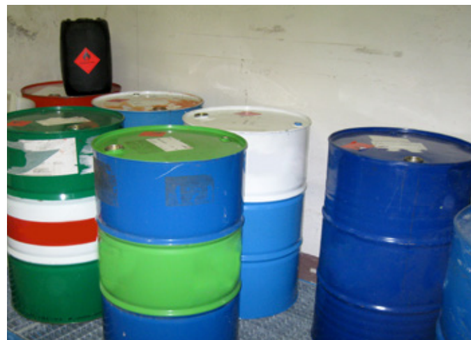
... et dans un compartiment coupe-feu séparé (aération ou ventilation) à partir de 450 litres.
