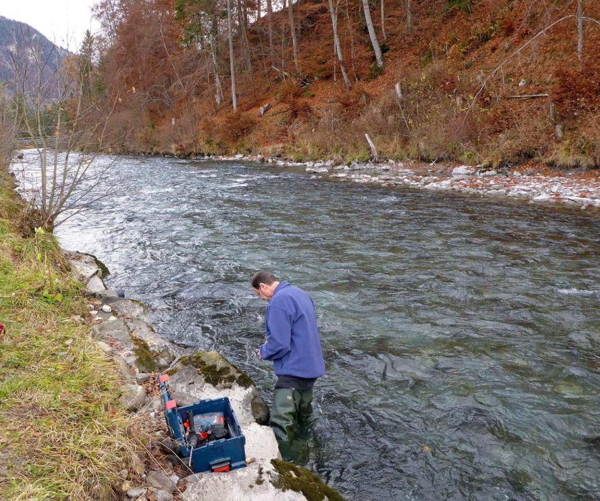
Installation d'un thermomètre automatique dans la Kander. Dans certaines rivières, le LPES mesure la température de l'eau afin de compléter les analyses biologiques et chimiques.
