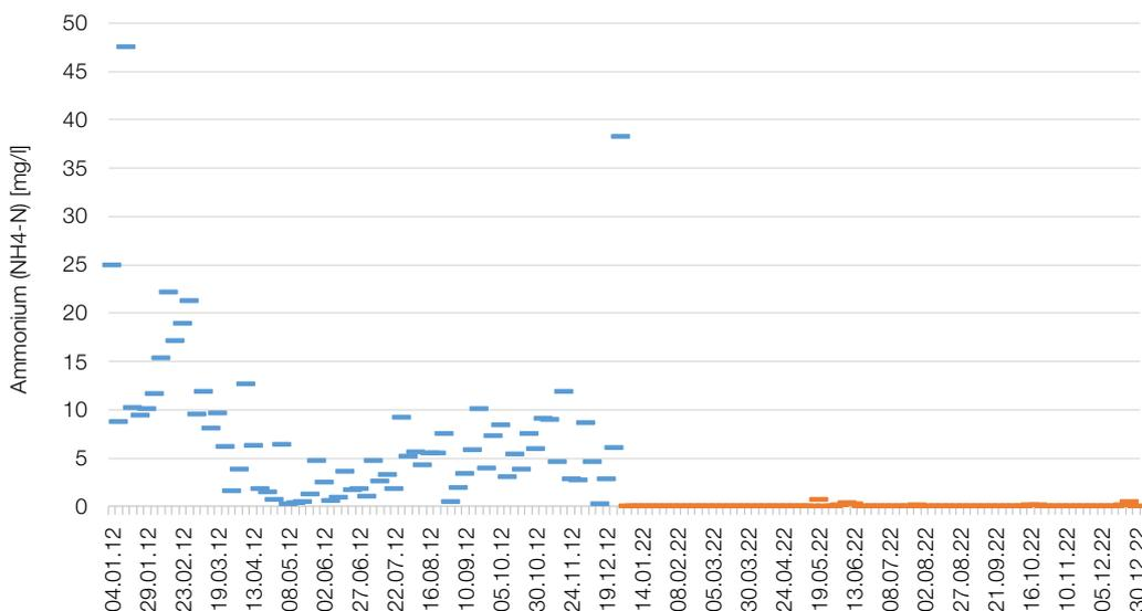
L'évolution de la concentration d'ammonium dans l'effluent de la STEP de Lauterbrunnen (Source des données: autocontrôle STEP) illustre à quel point le traitement des eaux usées s'est amélioré: les valeurs en bleu correspondent aux relevés de 2012, celles en orange aux mesures de 2022.
