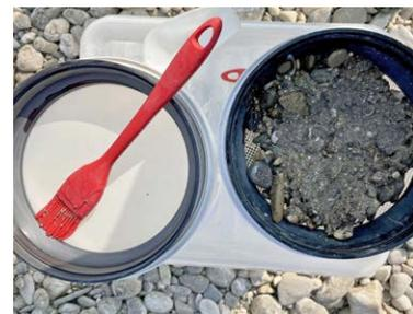
Pour obtenir du matériel de granulométries différentes pour les analyses en laboratoire, les sédiments prélevés sont tamisés sur place (ci-dessus : à Port, après la sortie de l'Aar du lac de Biemme ; à gauche : à Arch). L'époussette fixée au bout d'une tige télescopique sert à prélever des sédiments.
