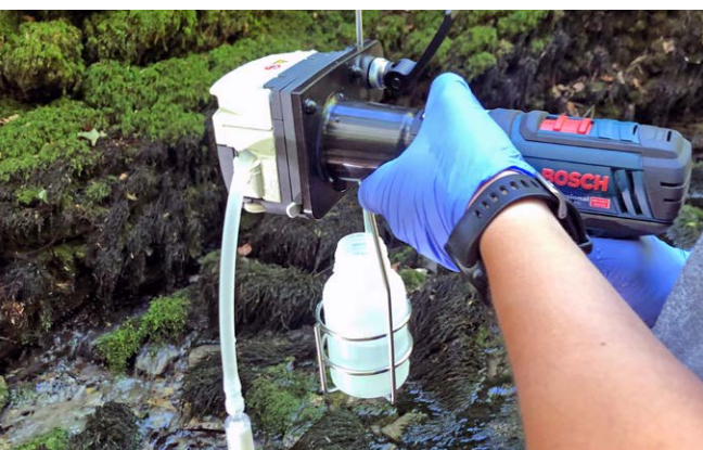
Prélèvement d'échantillons d'ADNe à l'aide d'une pompe péristaltique actionnée par une batterie : l'eau de source est pompée à travers un filtre qui retient le matériel génétique des organismes aquatiques.
