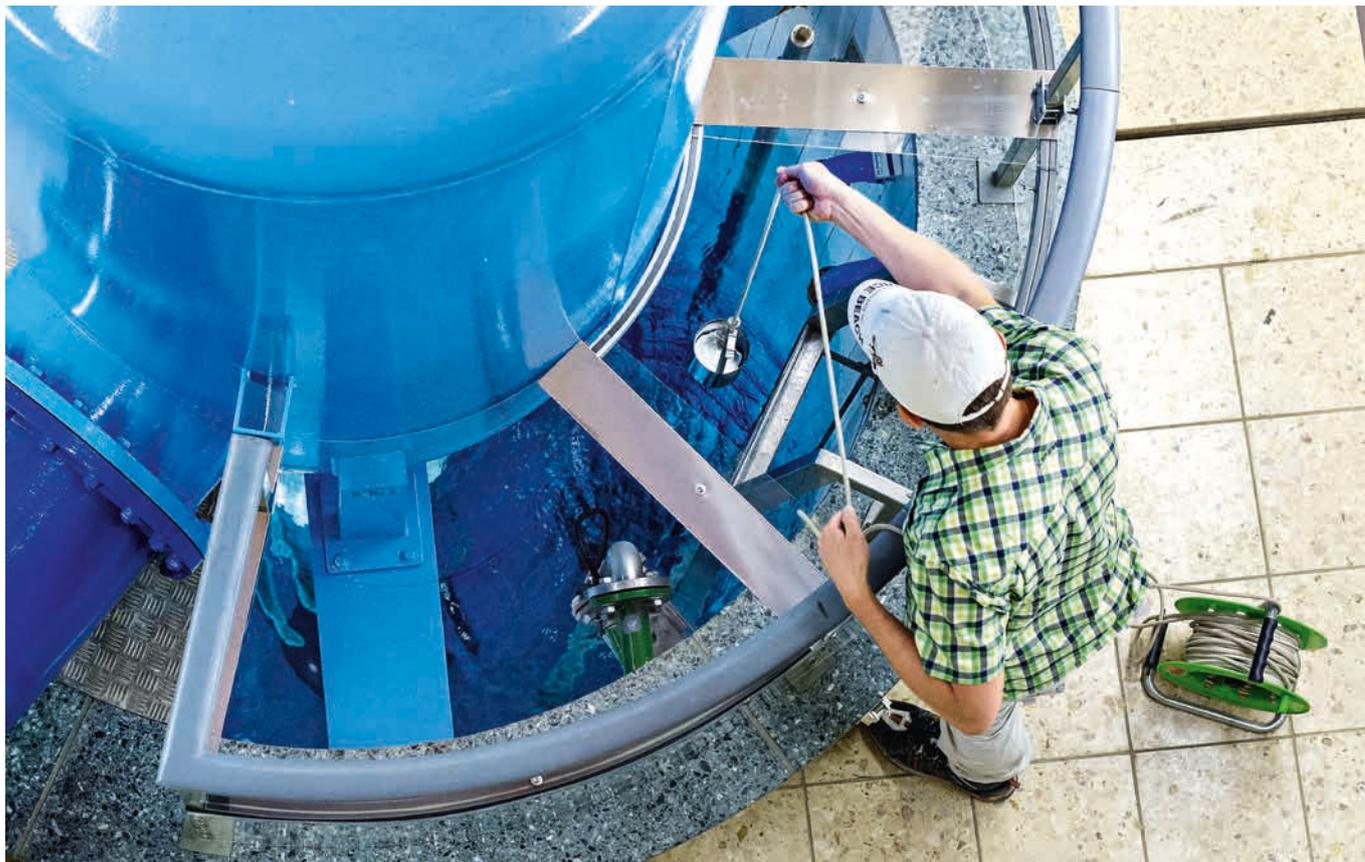
Prélèvement d'un échantillon d'eau souterraine dans un captage près de Neuenegg/Bramberg. Les eaux souterraines sont la principale ressource d'eau potable pour la population.
