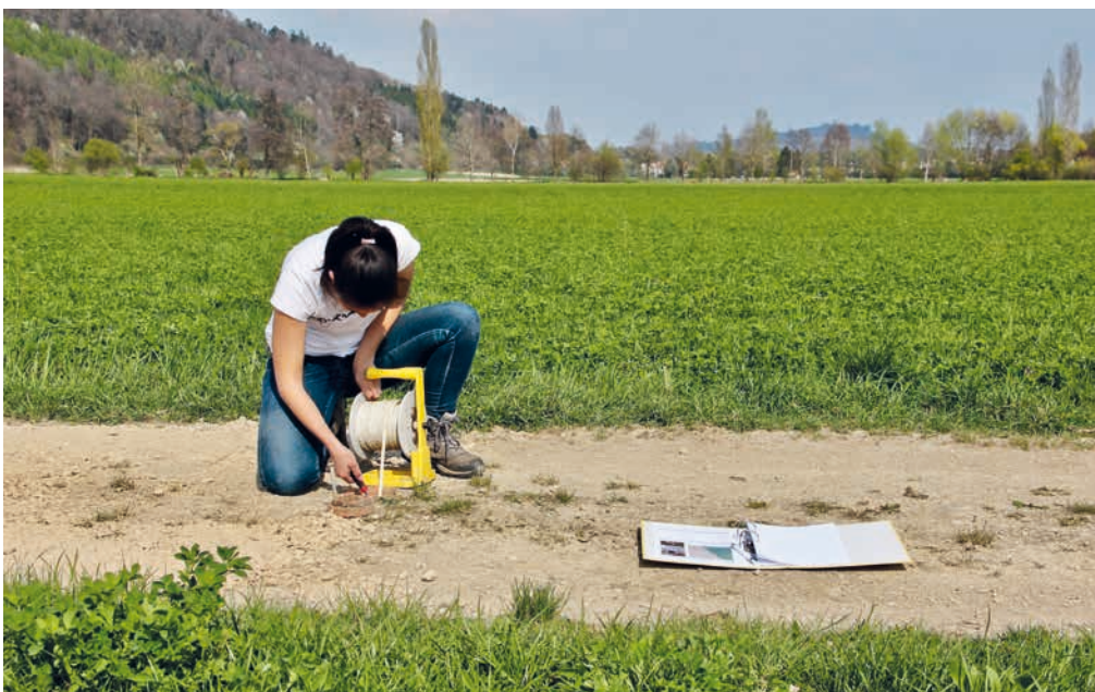
Détermination du niveau de la nappe souterraine lors de la campagne de mesure d'avril 2017.
