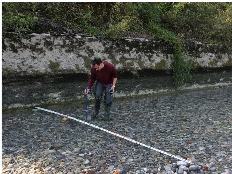
Mesure de l'étalonnage au moyen d'un moulinet
