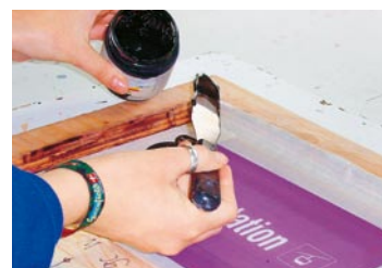
Fig. 20 Sérigraphie: le motif est imprimé sur le tamis. Les parties du tissu non recouvertes d'une lettre ne sont pas durcies par la lumière et sont donc lessivées au développement. L'encre est appliquée sur le tamis et passe au travers des parties perméables pour se déposer sur les indicateurs de direction.
