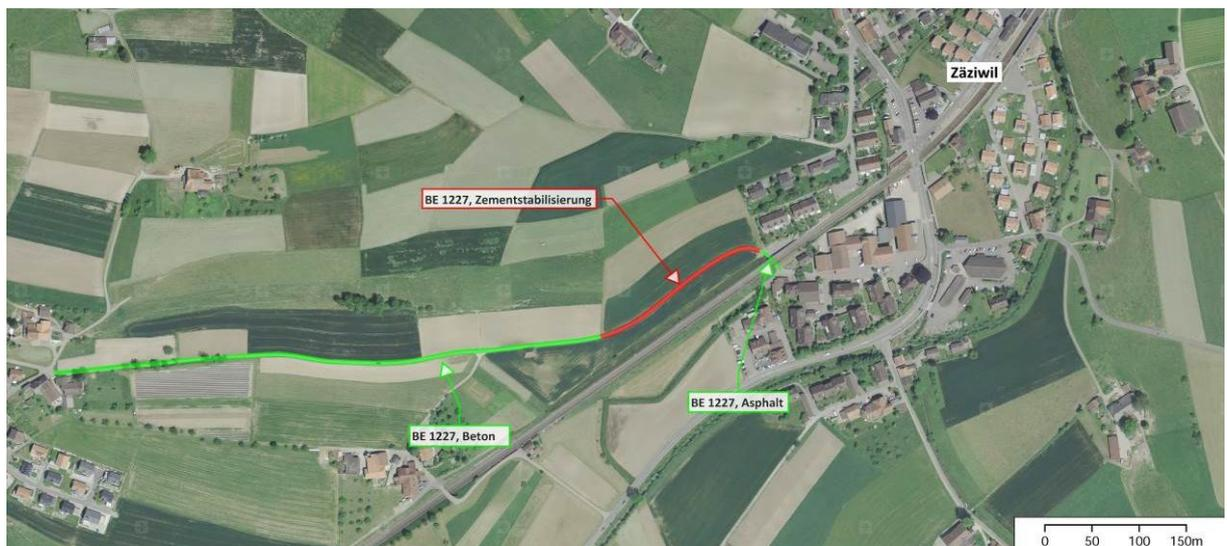
III. 50: Aperçu Mirchelgässli, Zäziwil. Tronçon assaini avec stabilisation au moyen d'un mortier (en rouge) et de béton (en vert).
